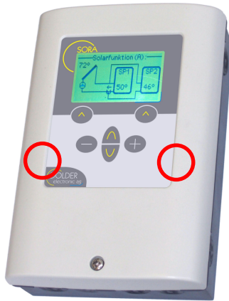
Figura 43: Chiusura dell'alloggiamento del regolatore
